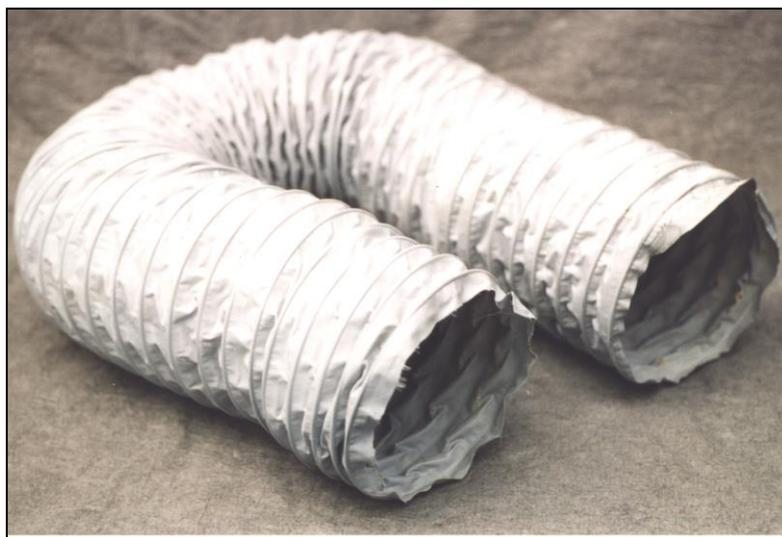
Tubo flessibile in fibra di vetro spalmata in PVC e con incorporata la spirale di rinforzo in acciaio idoneo per aspirazione e soffiaggio di ARIA e FUMI CALDI. Ottima resistenza alle alte temperature. Eccellente flessibilità.
